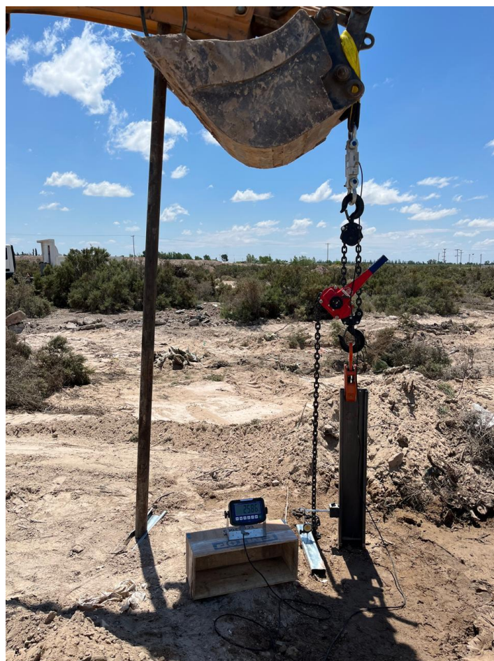
Imagen 4 - Ensayo tracción axial
