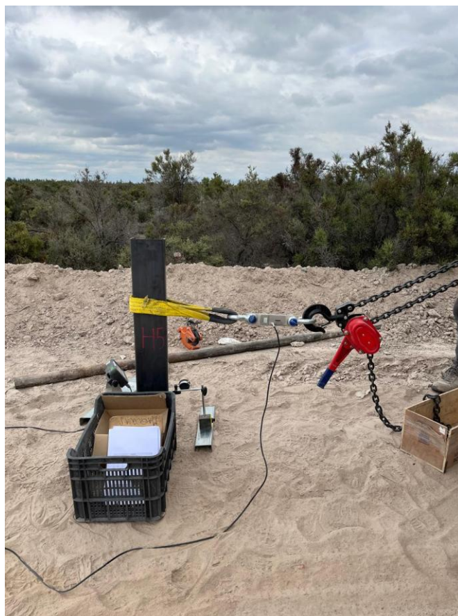
Imagen 3 - Ensayo tracción lateral
